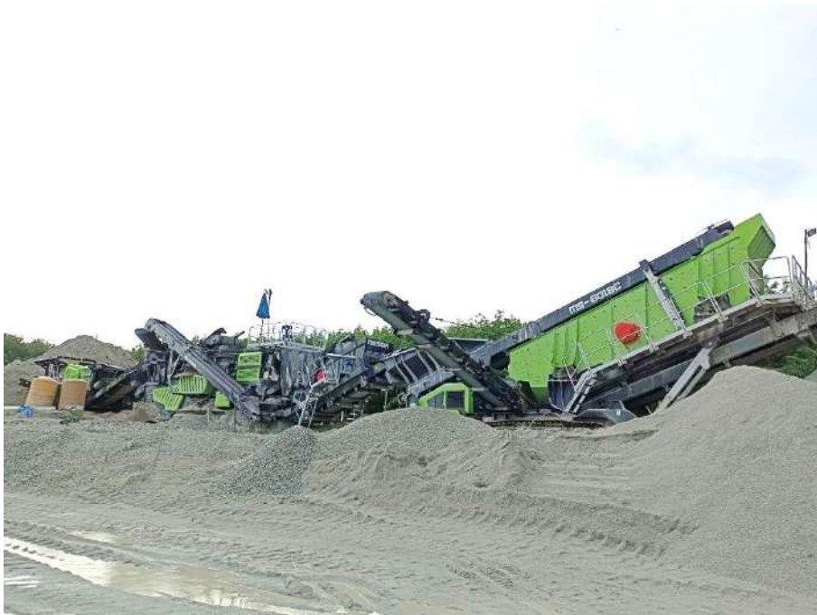
รูปที่ 10 โรงโม่หินแบบเคลื่อนที่ที่มีระบบป้องกันผลกระทบสิ่งแวดล้อม
