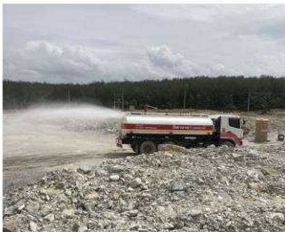
รูปที่ 12 การฉีดพรมน้ำบริเวณลานเก็บกองแร่ เส้นทางขนส่งแร่ และบริเวณพื้นที่โครงการ
